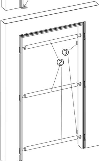
Setzen Sie die Türfutterspreizen an den Band- und Schließblechpunkten ein **2** um einen einwandfreien Sitz zu gewährleisten, und bringen Sie die Zarge mittels Keilen **3** in eine lot- und waagerechte Position in der Wandöffnung. Bei Einsatz von Türblättern mit einem Gewicht > 40 kg muss der Bereich der unteren Bandaufnahme **3** und des oberen Schließblechteiles dauerhaft druckfest hinterfüllt werden. Vor dem Verschäumen ist das Zargenfalzmaß auf Höhe der Türfutterspreizen nochmals zu prüfen.
