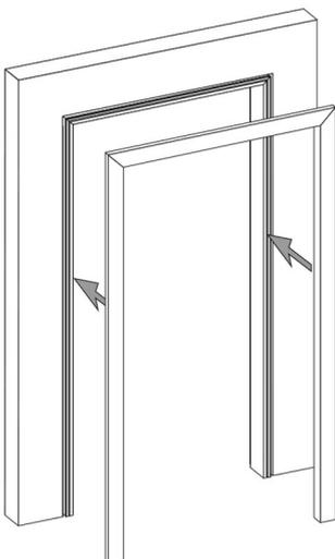
Geben Sie nun zur Befestigung der Zierbekleidung auf der Rückseite des Türfutters punktweise Weißleim in die Längs- und Quernut, und schieben Sie die Zierbekleidung auf. Durch leichte Schläge mit der Hand (oder einem Gummihammer) wird die Zierbekleidung endgültig fixiert. Abschließend versiegeln Sie die Anschlussfuge Zarge - Boden dauerelastisch ⑨.
