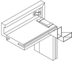
Die konisch geformten Gehrungsschutzecken dienen der Fixierung der Zargengehrungen. Die Schutzecken werden in die Nut für die Falzbekleidung geschoben, wo sie bis zur Aushärtung des Leimes verbleiben.
